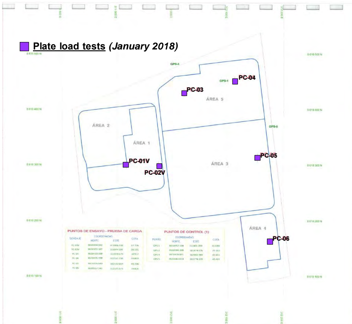
Figura 12. Ubicación de los ensayos de placa de carga en el Proyecto.
