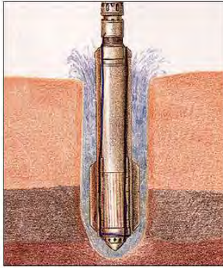
Ilustración 2 Esquema de ejecución de Columnas de Grava por vibrosustitución .
