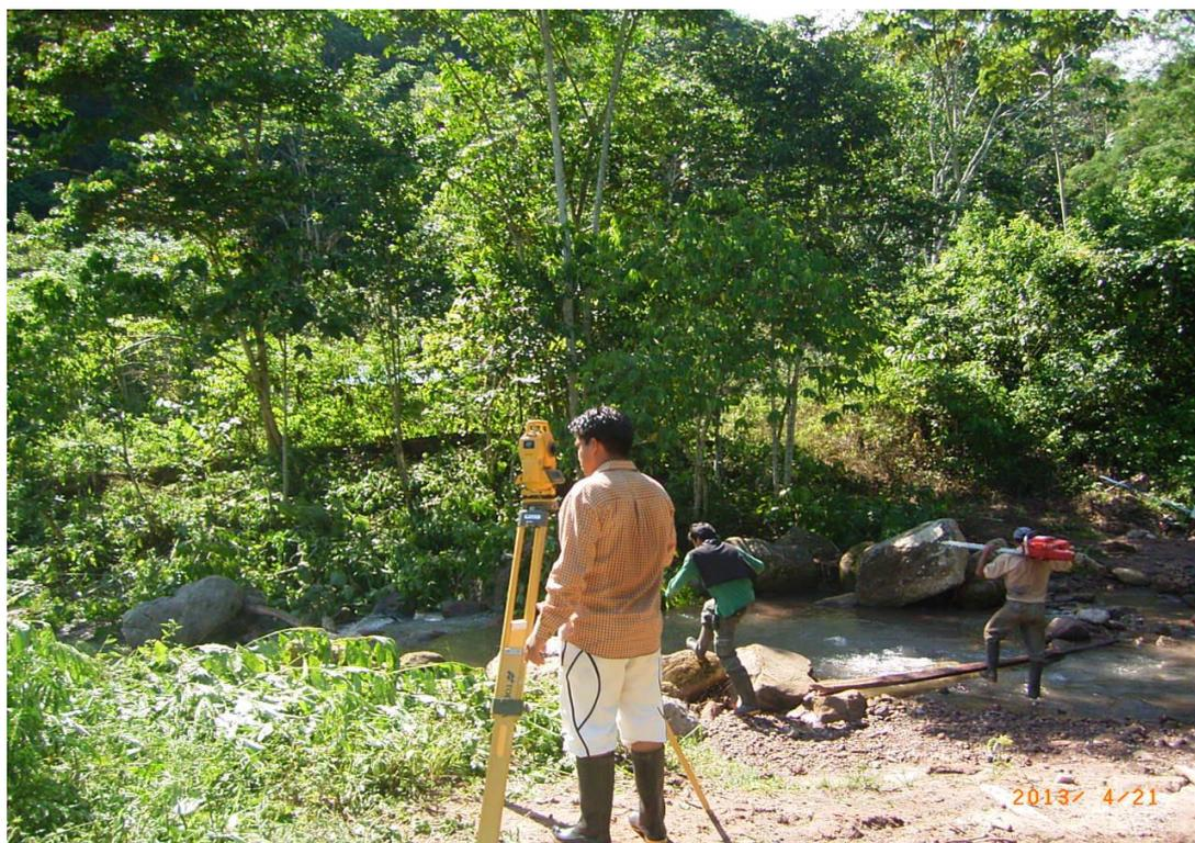
Figura 4: Uso de estación total en el levantamiento topográfico. *Fuente:* Adaptada del Consorcio, 2019.
