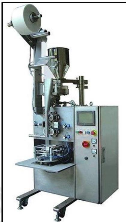
*Figura 18.* Máquina empacadora marca CAMA modelo DXDC50B
