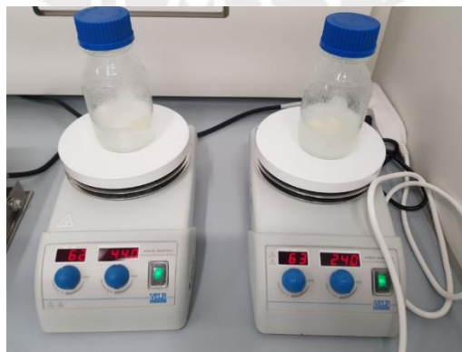
2. Desmineralizado con agitación magnética y temperatura controlada
