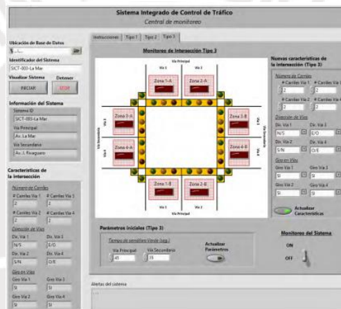
Figura 2.5.- Interfaz del Sistema Integrado de Control de Tráfico
