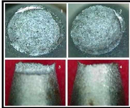
**Figura 19: Fractografía de probeta fracturada a 200° C 1) superficie extremo superior, 2) superficie extremo inferior, 3) y 4) vistas del extremo inferior [15]**
