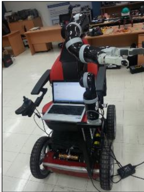
Figura 4.7: Simulación del movimiento del robot MICO Arm mediante un ordenador Fuente: Elaboración propia
