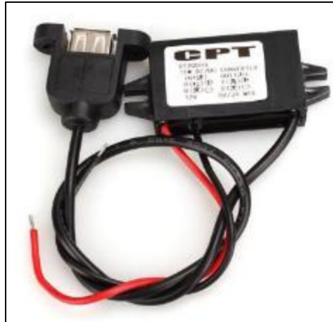
Figura 3.29: Regulador de voltaje 24V a 5V 3 A de la marca CPT Fuente: www.dhgate.com
