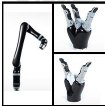
Figura 3.16: Izquierda: Brazo. Derecha: pinza de 2 dedos y pinza de 3 dedos. Fuente: www.kinovarobotics.com
