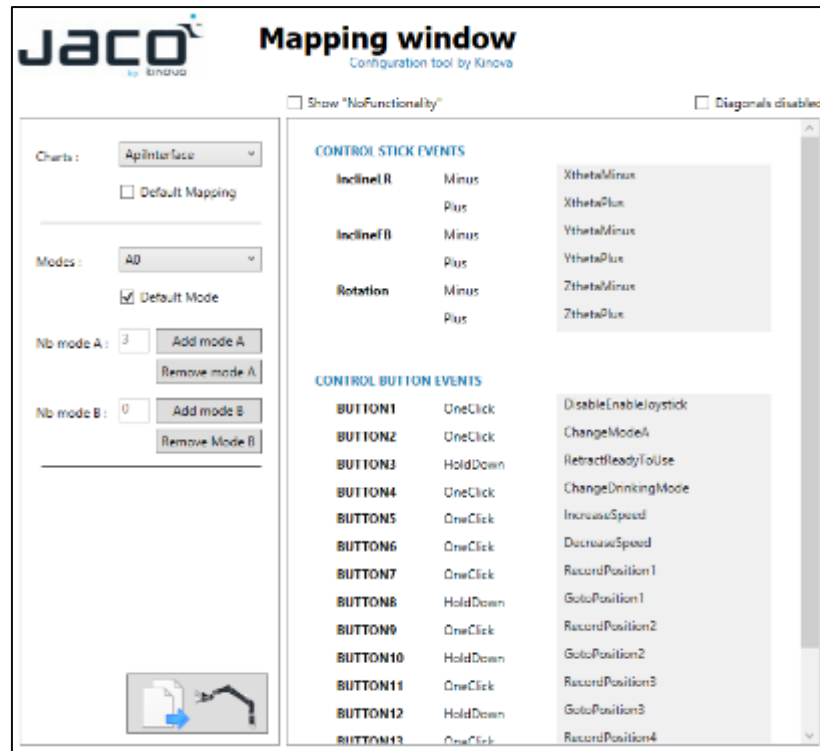
Figura 4.5: Ventana “Mapping” para la configuración de los comandos que representaran a los botones del joystick Fuente: JACOSOFT
