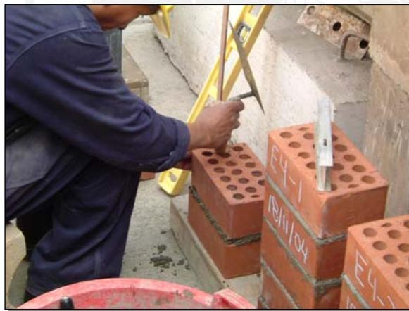
El espesor de las juntas de mortero fue de 1 cm y se controló este grosor con una regla de madera (escantillón), previamente a esta regla se le hacen unas marcas que indican la altura de cada una de la hiladas a colocar.
