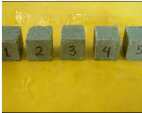
Luego de 28 días, las probetas de mortero se retiran del agua para ser medidas y ensayadas.
