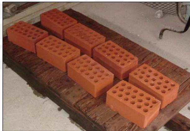
Para la tercera serie se utilizó el ladrillo de arcilla industrial King Kong 30% de la ladrillera Lark S.A. con dimensiones nominales de 9 x 12.5 x 23 cm y perforaciones circulares perpendiculares a la cara de asiento que proporcionan 30% de vacíos (figura 5.2). Para la cuarta
