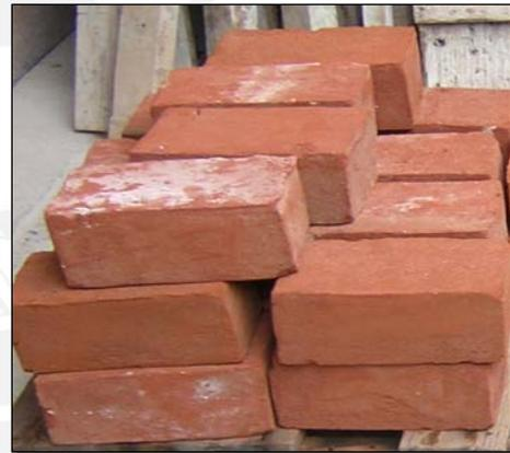
En las cuatro series se realizó una selección y limpieza de las unidades, eliminando aquellas que presentaban rajaduras o esquinas dañadas, buscando de esta manera uniformizar las unidades de albañilería.
