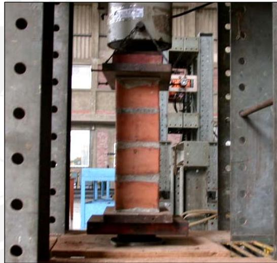
El ensayo de compresión axial fue de carga controlada, a una velocidad de 5 ton/min. Las cargas fueron aplicadas hasta provocar la rotura de las pilas, instante donde se registró la carga máxima que puede soportar la pila de albañilería.
