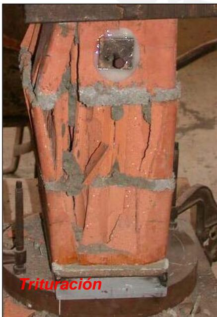
Figura 8.2. Falla por trituración de la pila de albañilería.
