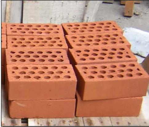
Figura 5.2. Fotografía de las unidades de albañilería industrial de la ladrillera Lark.
