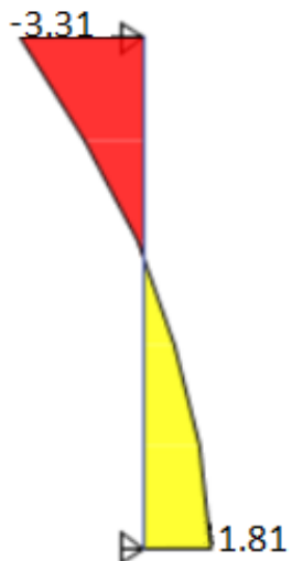
Figura 9.11 DFC de muro de cisterna
