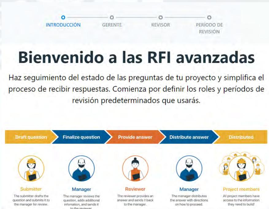
Figura 22. Flujo del RFI usando PlanGrid
