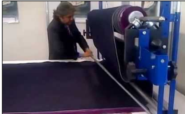
Figura 18: Máquina tendedora Fuente: Empresa ABC
