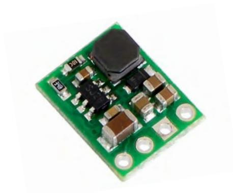
Figura 4.16 Regulador de 5V Pololu *step-down* D24V3F5.<sup>18</sup>
