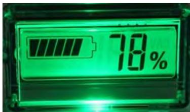
Figura 4.10 Medidor de batería BaiWay TH01 V6.<sup>13</sup>
