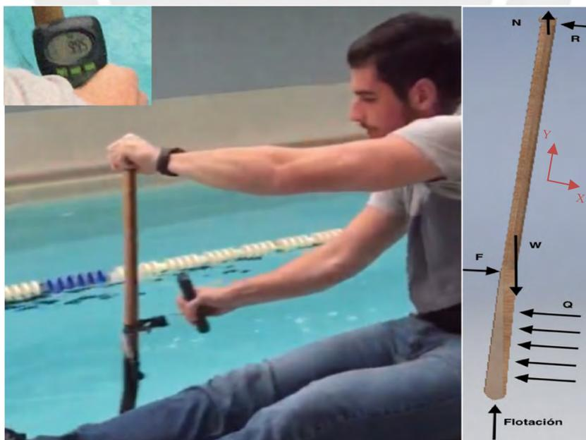
Figura 3.2 Experimento para hallar la fuerza máxima de remado de manera práctica y DCL del sistema en remado.
