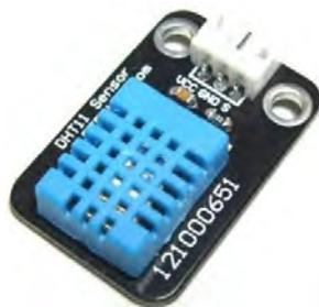
Figura 4.13 Sensor de humedad DHT11.<sup>15</sup>
