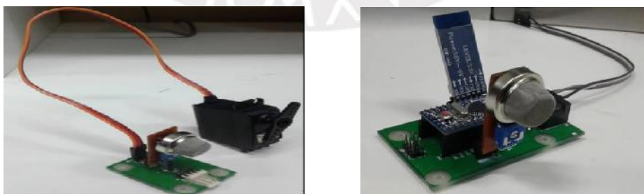
Figura 35. Tarjeta de sensado de GLP (sensor 1) [Elaboración propia].
