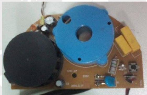
Figura 28. Tarjeta de detección de humo y accionamiento de la alarma [Elaboración propia].
