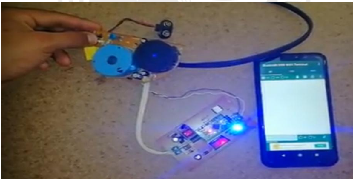
Figura4. Dispositivo superior con el detector de humo activado y envío de tramas al dispositivo móvil
