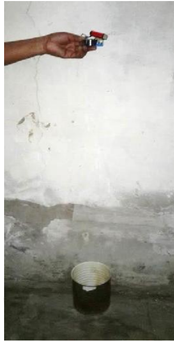
Figura 29. Prueba de detección de humo a 1.20mt sobre la fuente de humo
