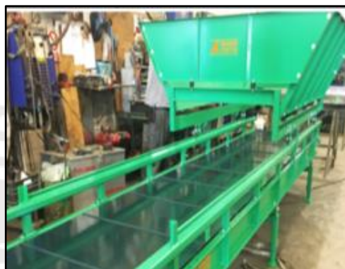
Figura 4.7: Tolva con cinta transportadora. Fuente: Empresa Bandas Cortés
