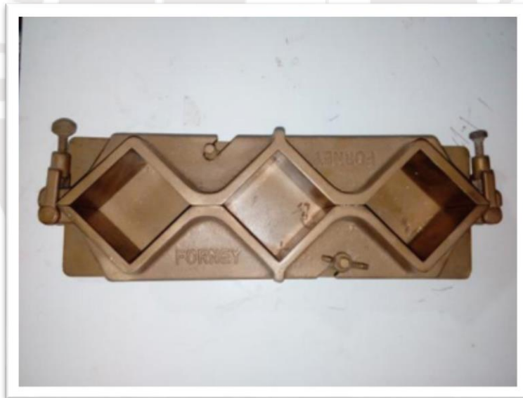
Fotografía 2: MOLDE PARA EL ENSAYO A COMPRESIÓN DEL ADOQUÍN DE CONCRETO.
