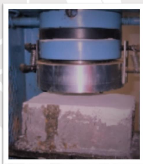
Fotografía 3: ENSAYO DE COMPRESIÓN DEL ADOQUÍN CONVENCIONAL
