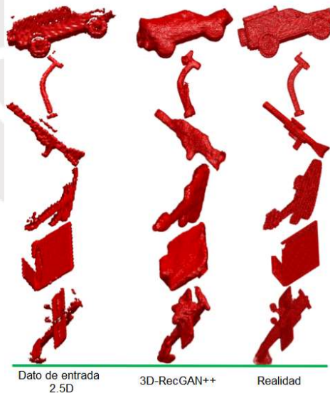
Figura 4. El método 3D-RecGAN++ reconstruye completamente una forma 3D a partir de una única vista de profundidad 2.5D (Yang et al., 2018).
