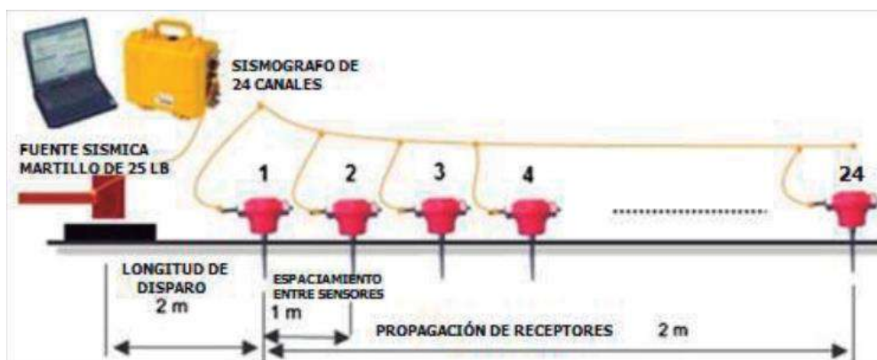
Figura 28. Línea sísmica del ensayo MASW y MAM.
