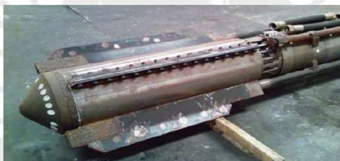
Figura 12. Equipo de vibrocompactación.
