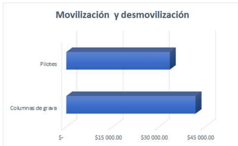
Figura 84. Comparativa de costes: movilización y desmovilización.
