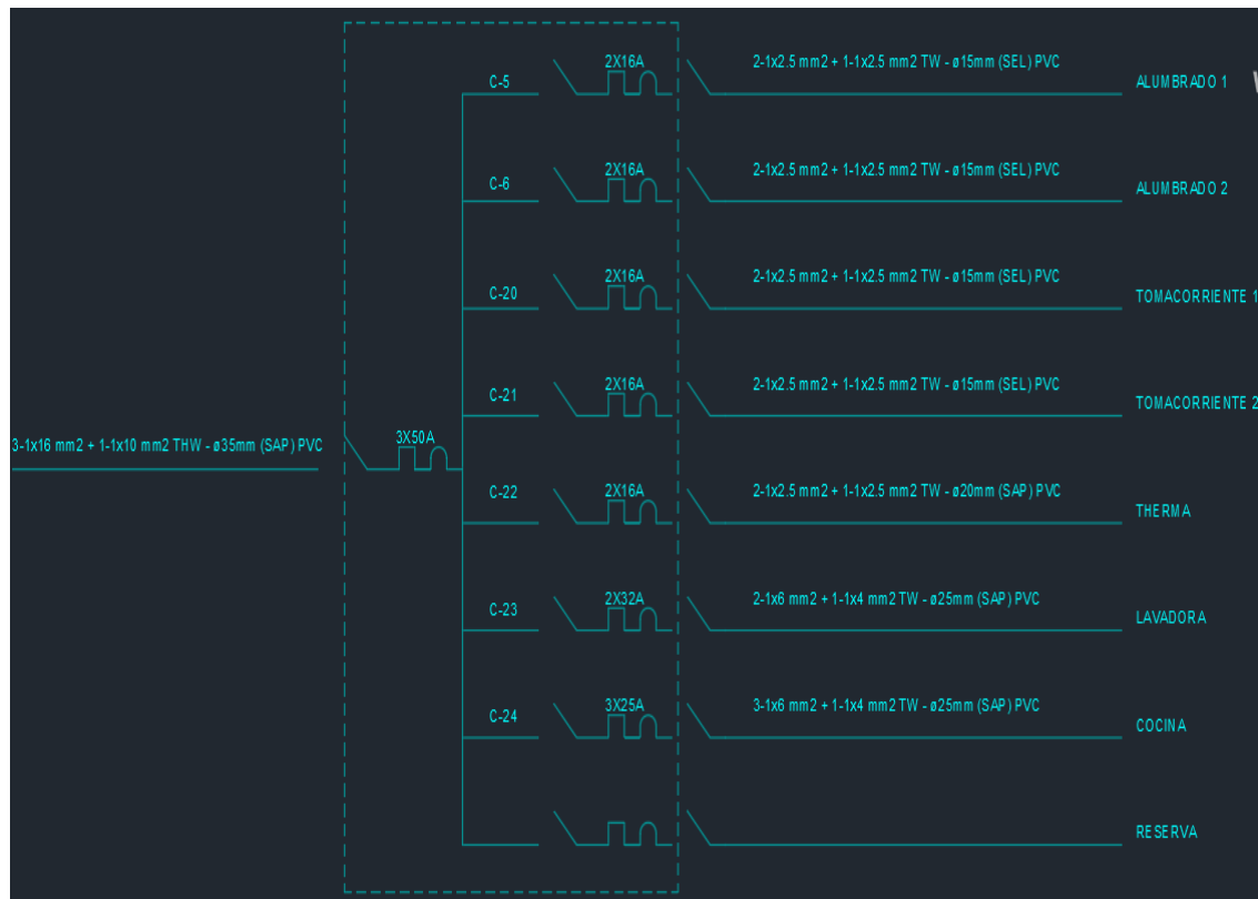
Figura 34. Esquema del tablero de distribución para los departamentos típicos
