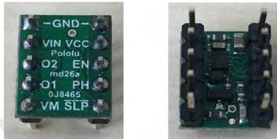
Figura 4.6 - Tarjeta electrónica del driver DRV 8838.
