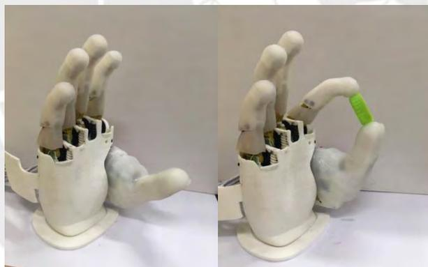
Figura 4.17 - Modo de reposo y gesto en pinza (t=0.42s)
