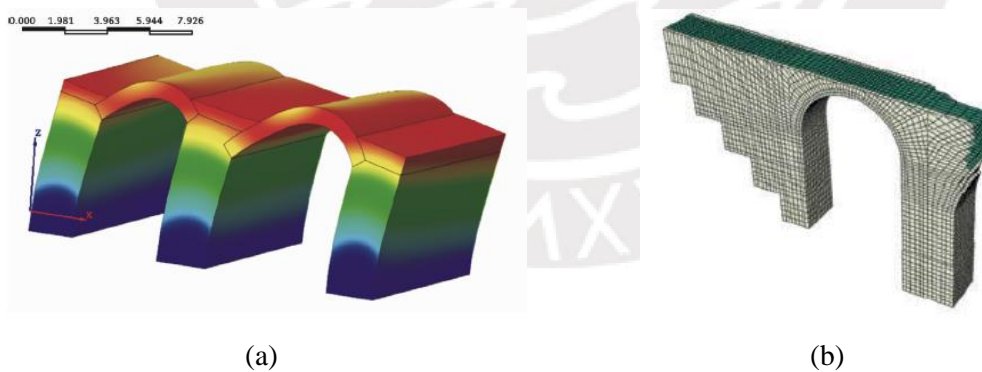
Figura 4.8. Ejemplos de condiciones de borde laterales: (a) primer modo de vibración Puente Florence-Bologna (Barbieri, 2018, 6(1), p. 58) y, (b) modelo de apoyo escalonado de Ponte di Augusto (Bertolesi et al., 2017, 11(5), p. 726).
