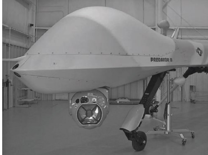
Figura 1.3 Ejemplo de un UAV equipado con un payload. Fuente: [4]
