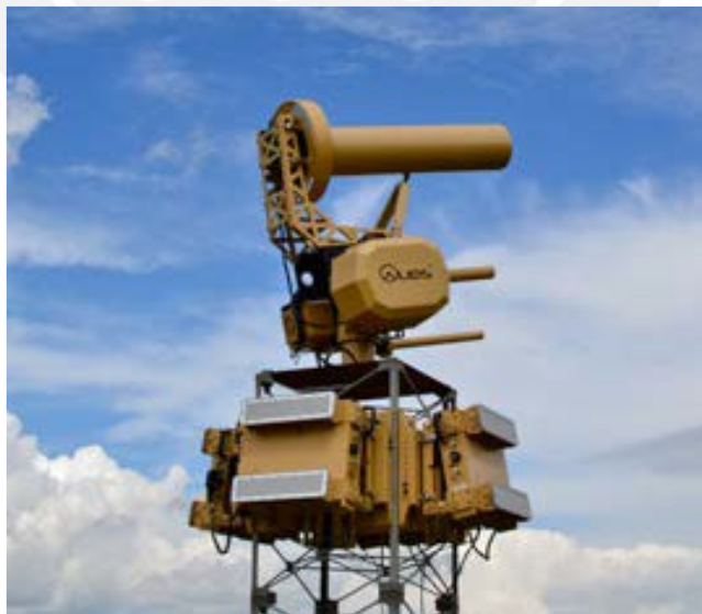
Figura 1.7 Ilustración de un sistema C-UAS. Fuente: [6]
