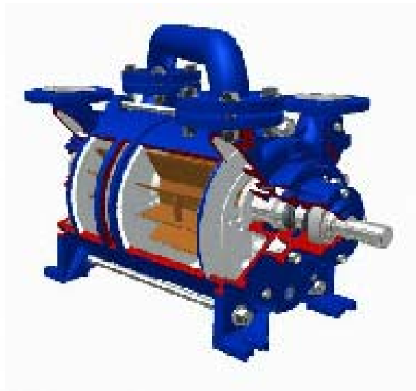
Fig. 21 Bomba de paletas convencional utilizada para generación de vacío
