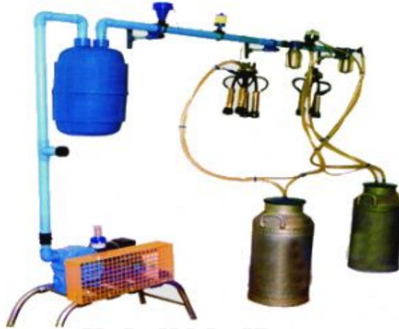
Fig.22 Estación de ordeño simple a tarro con dos puntos de ordeño
