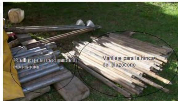
**Figura 13.** Tipos de varillaje para ensayo CPTu (Díaz, 2011).
