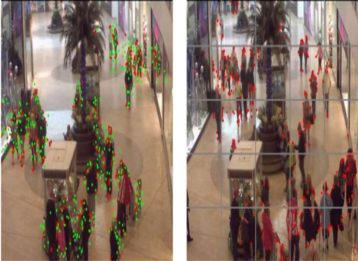
Figura 2-7: Ejemplo de detección de los puntos de interés (verdes SURF y rojos BRISK) (Jeong, Kim,, 2018).
