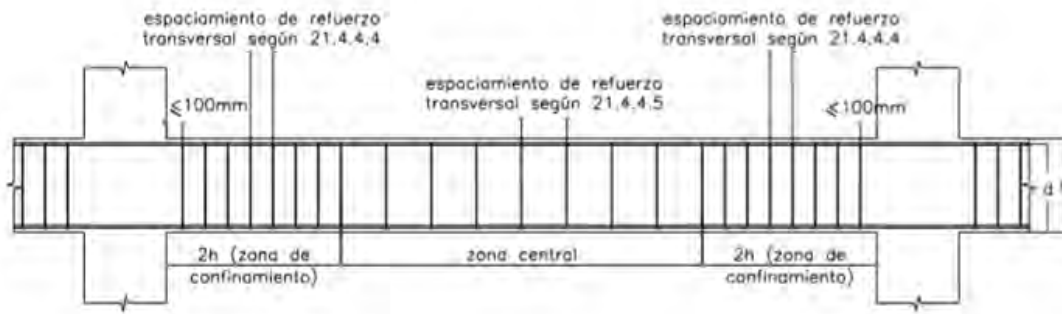
Figura 29. Requerimiento de estribos en vigas (Norma E.060).
