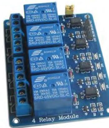
Figura 4.64 Módulo de 4 relés SRD-05VDC-SL-C.
