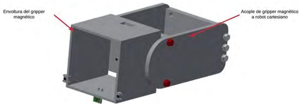
Figura 4.23 Subsistema de sujeción del dron.
