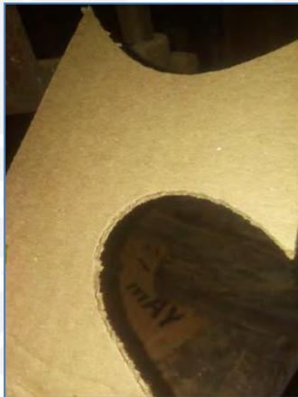
Figura A9: Corte de cartón ondulado en máquina de corte para muebles
