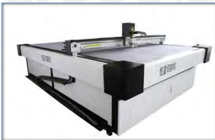
Figura 18. Plotter de corte CNC.
