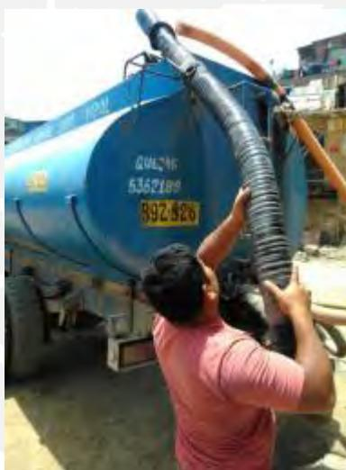
Imagen 3. Cisternas que abastecen a los tanques de pilones y domicilios
