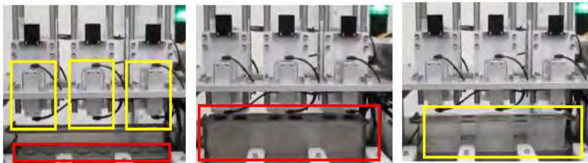
(a) Plataforma retraída (b) Plataforma durante su elevación (c) Succión de los recipientes
