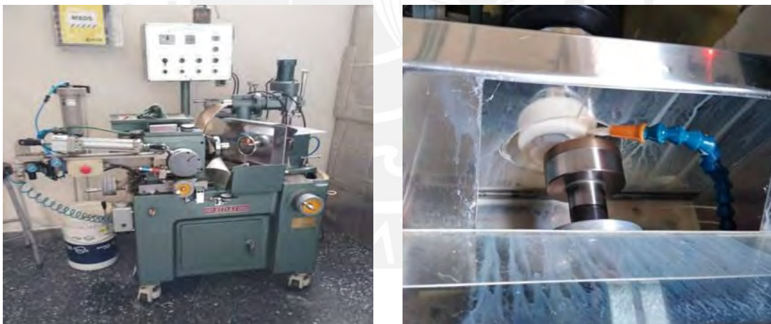
Figura 14. Máquina generadora de curvatura en los vidrios y sujetador utilizado
