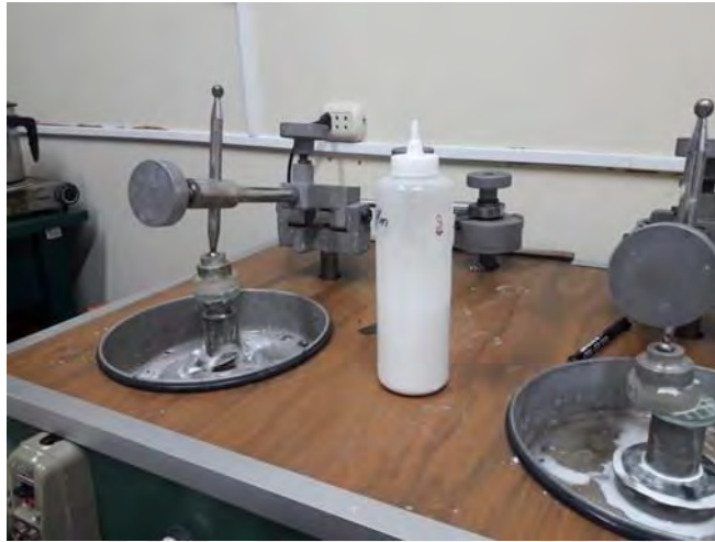
Figura 20. Proceso de esmerilado de superficies
