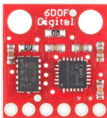
Figura 1.30. IMU de 6 grados de libertad 18
