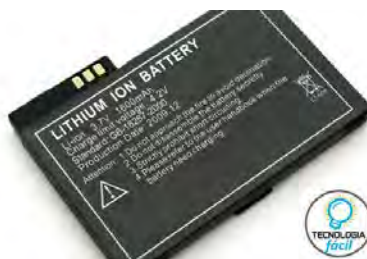
Figura 1.36. Batería de iones de Litio 25
