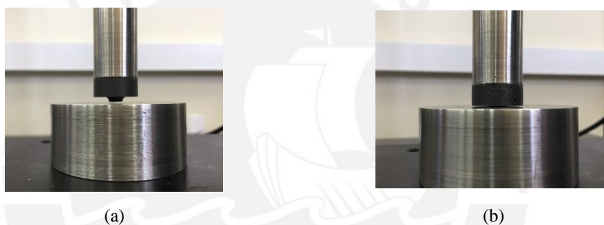
Figura 3.8. (a) Probeta sin carga, (b) probeta comprimida a 400 N.
