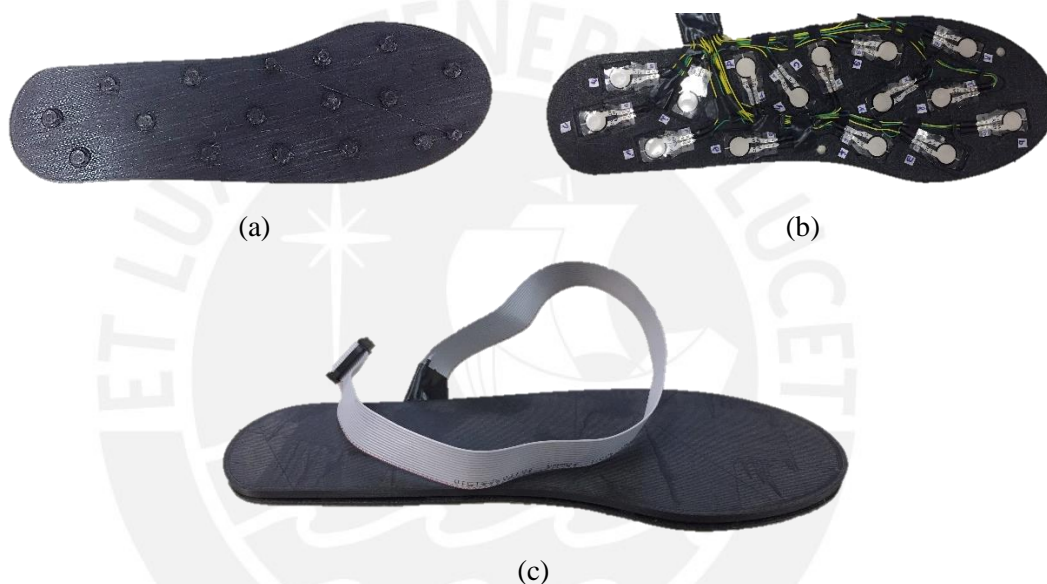
Figura 4.6. Plantilla fabricada por impresión 3D: (a) capa superior, (b) capa inferior y (c) plantilla ensamblada
