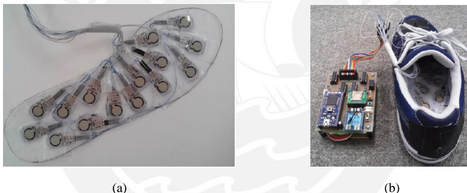
Figura 1.10. (a) 15 sensores Flexiforce montados en una plantilla, (b) Circuito electrónico conectado a los sensores. Fuente: [25]
