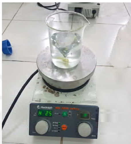
Figura 10 Disolución de los reactivos con un agitador electromagnético
