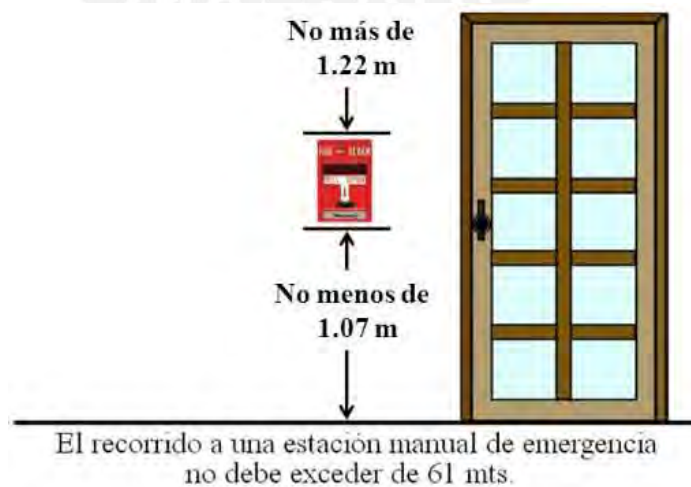
Figura 4.19: Instalación de estación manual. Fuente: [1]
