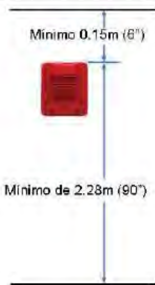
Figura 4.4: Montaje en pared de Sirenas. Fuente: [1]
