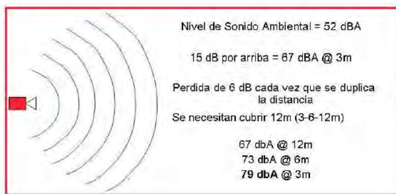
Figura 4.3: Ejemplo de protección con sirenas. Fuente: [1]
