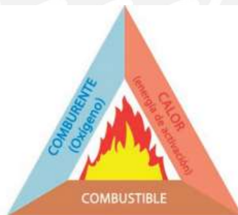
Figura 2.2: Triángulo del fuego. Fuente: [8]
