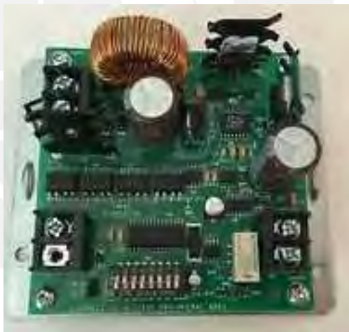
Figura 4.21: Módulo releasing. Modelo: 4090-9906. Marca: Simplex. Fuente: [20]
