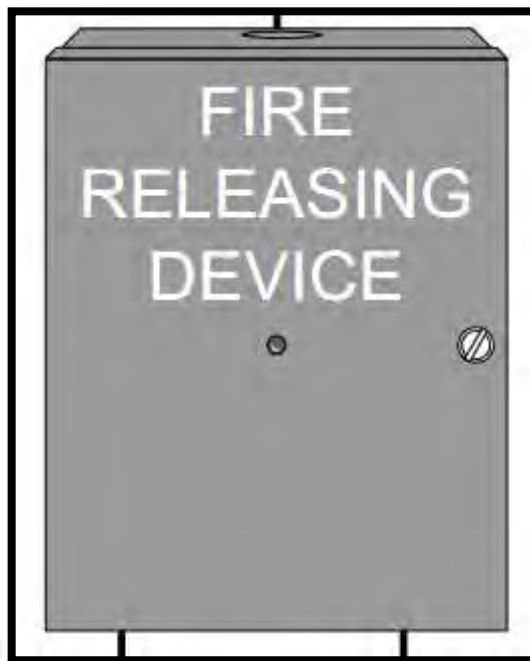
Figura 2.32: Módulo de descarga. Fuente: [20]
