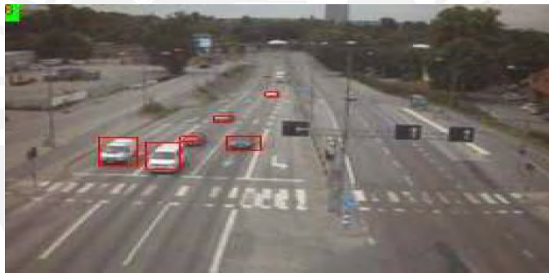
Figura 2.20: Algoritmo para detectar y contar vehículos en movimiento en una autopista [Abbas, 2013].
