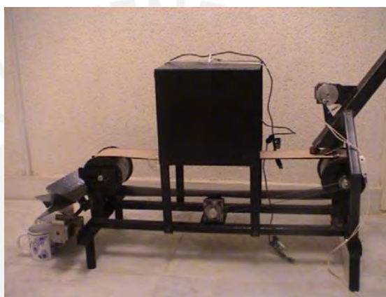
Figura 1.1: Diseño e implementación de un sistema de clasificación de dátiles basado en visión por computadora [Al, 2010].
