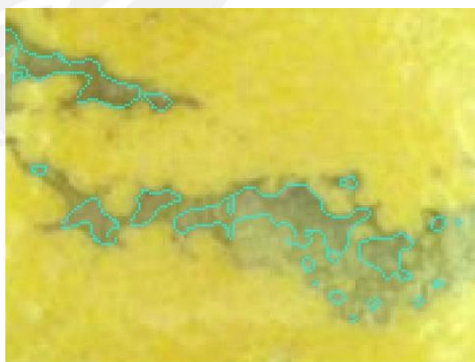
Figura 4.6: Ampliación de la zona defectuosa detectada por la red neuronal.
