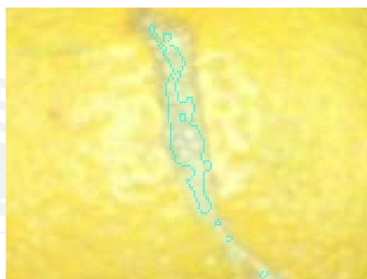
Figura 4.14: Ampliación de la zona defectuosa detectada por la red neuronal.
