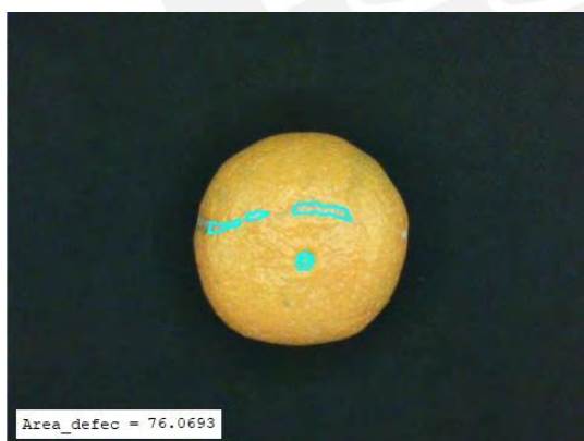
Figura 4.15: Mandarina 2 con daño por rameado. Reconocimiento y medición del área defectuosa en mm 2 .
