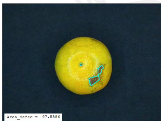
Figura 4.19: Mandarina 4 con daño por oleocelosis. Reconocimiento y medición del área defectuosa en \text{mm}^2 .
