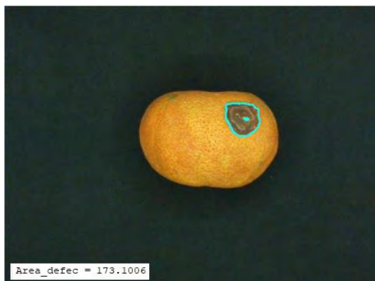
Figura 4.17: Mandarina 3 con daño por oleocelosis. Reconocimiento y medición del área defectuosa en \text{mm}^2 .
