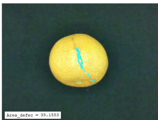
Figura 4.13: Mandarina 1 con daño por rameado. Reconocimiento y medición del área defectuosa en mm 2 .
