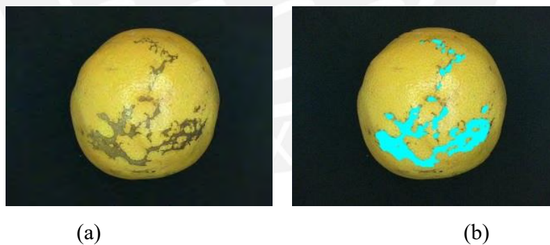
Figura 3.22: Detección de defectos. (a) Imagen de ingreso a la red neuronal, (b) Salida de la red neuronal.
