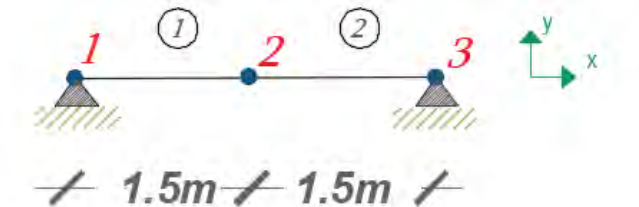
Figura 8.5 Viga, análisis unidimensional
