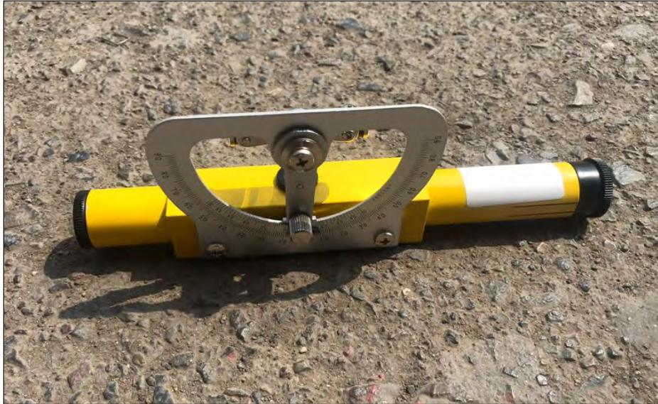
**FIGURA 3.2.2: Eclímetro utilizado para obtener la pendiente de las vías.**
