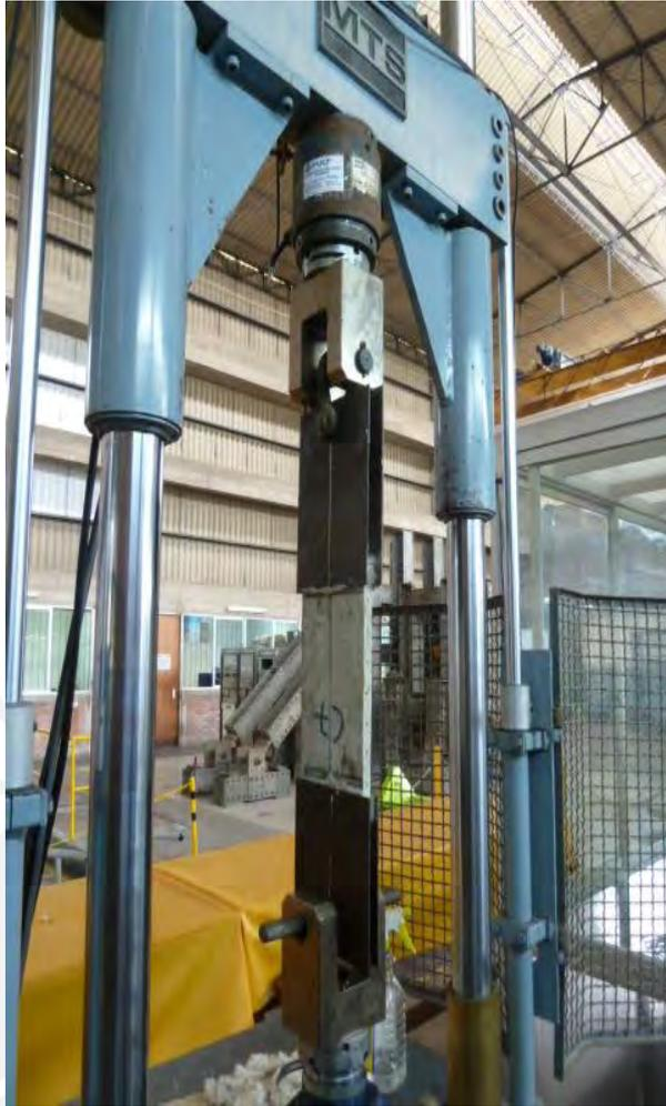
*Figura 27 - Espécimen alineado en la dirección de la carga*
