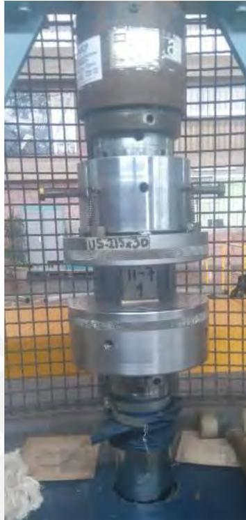
*Figura 14-Ensayo de compresión del cubito de mortero*
