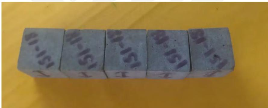
*Figura 13- Retiro de los cubitos del molde después de 24 horas.*
