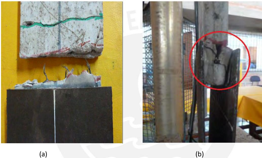
Figura 29-Modos de falla del sistema FRCM (geomalla y mortero): resistencia última a tracción de la geomalla;(b) desprendimiento del mortero.
