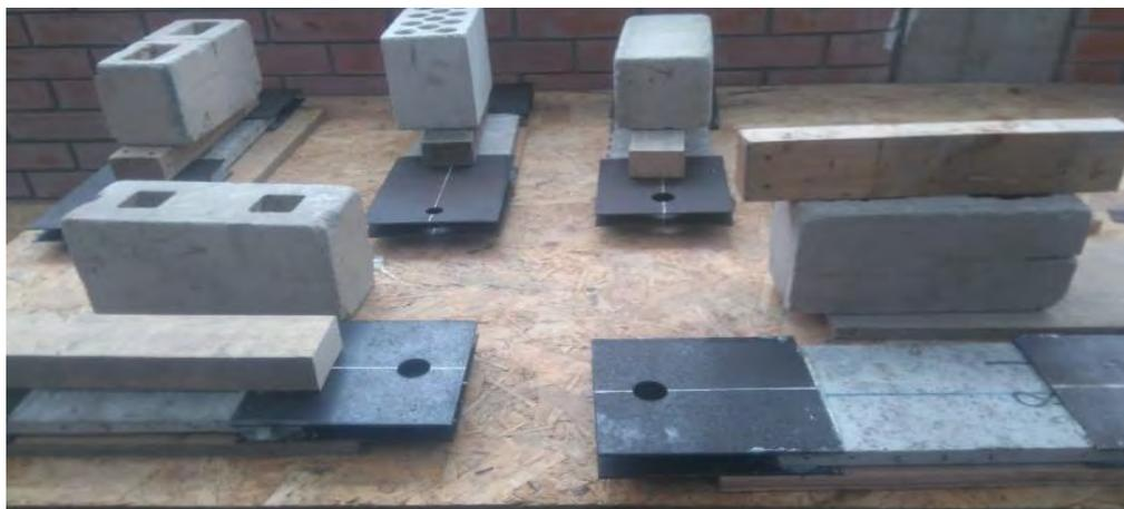
*Figura 24-Pegado de las lengüetas de acero en los especímenes.*
