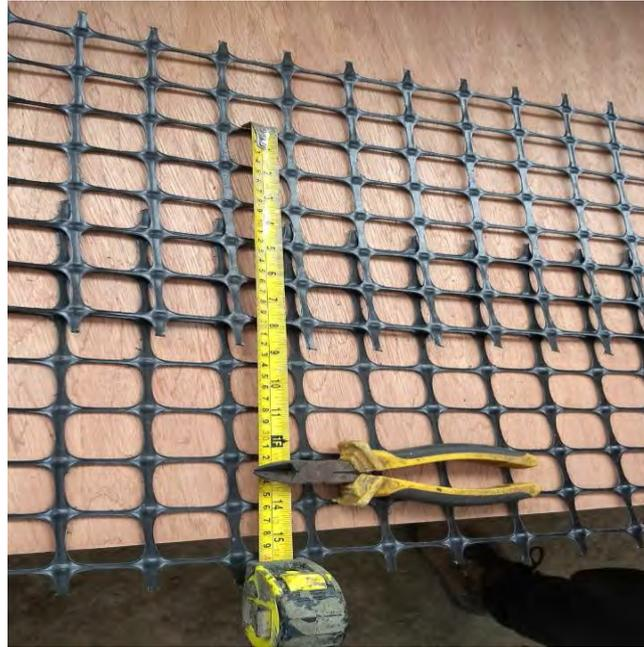
*Figura 16- Geomalla biaxial a usar para el sistema de reforzamiento FRCM.*
