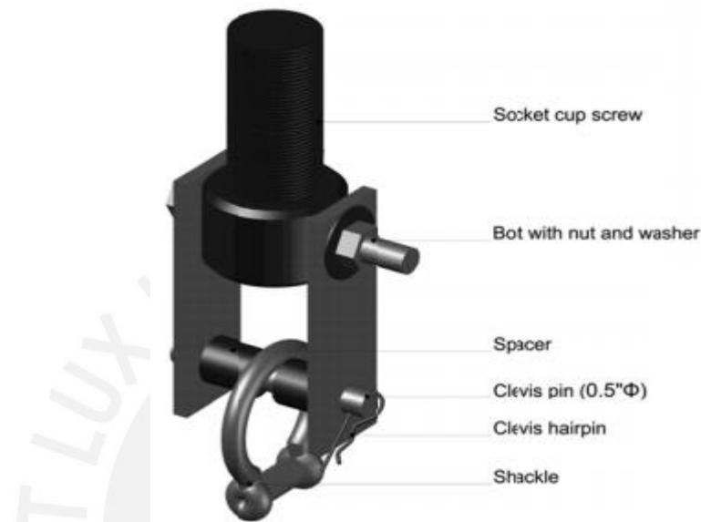
Figura 26- Modelo de sujetador tipo grillete. (Fuente: AC434 2016)
