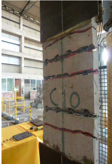
Figura 30-Desarrollo de múltiples fisuras durante el ensayo a tracción del sistema FRCM
