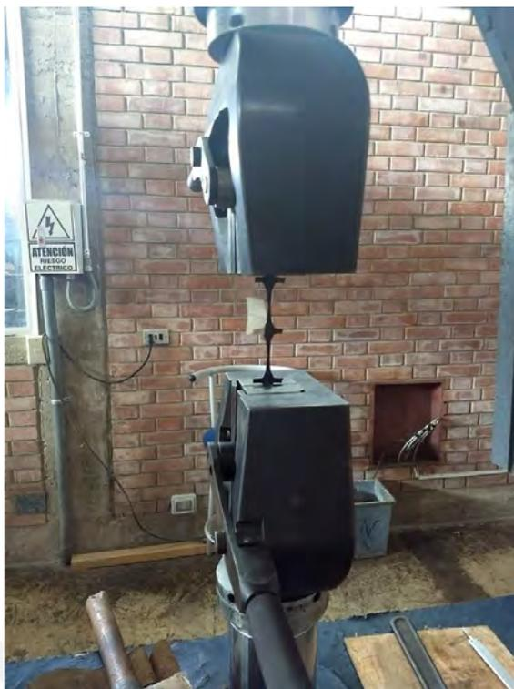
*Figura 17-Ensayo a tracción de una costilla de la geomalla.*
