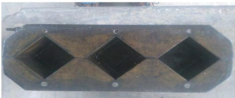
Figura 11-Molde cubierto con desmoldante para la preparación de los cubitos
