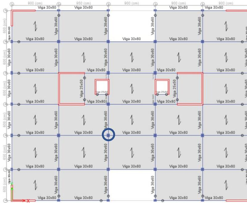
Figura 8.1. Ubicación en planta de la columna C-1. (Fuente: Propia).
