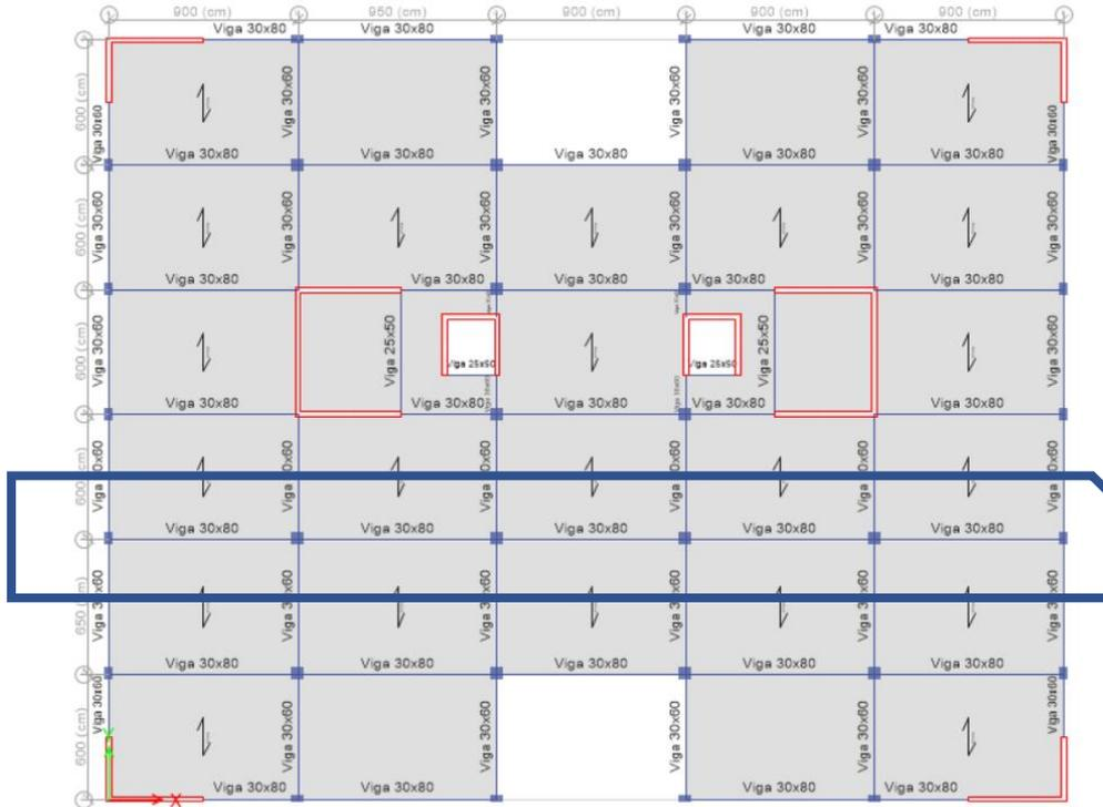
Figura 7.6. Ubicación en planta de la viga V4 (Fuente: Propia).
