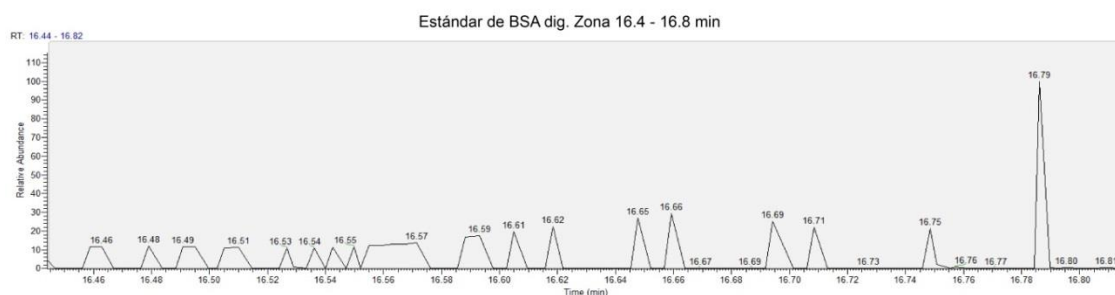
Figura A13. Cromatograma del análisis por nanoLC-ESI para el estándar de BSA digerido. Acercamiento del cromatograma 4) de la Figura 19 en la zona de 16.4 - 16.8 minutos.
