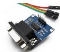
Figura 3.21: Conversor de RS232 a TTL Fuente: [61]
