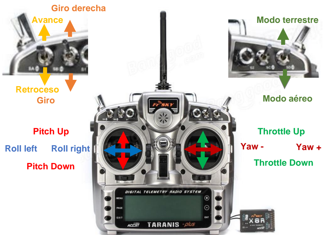
Figura 3.51: Indicación de canales usados y señales que envía el FrSky
