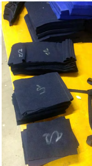
Figura 70: Marcado e inspección de cortes
