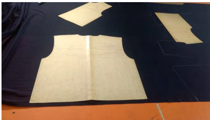
Figura 66: Pre trazado de tela - buzo sin forro
