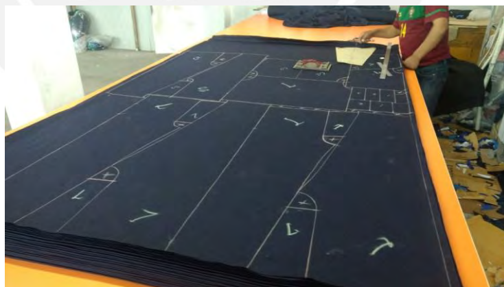
Figura 68: Trazado de tela – buzo sin forro
