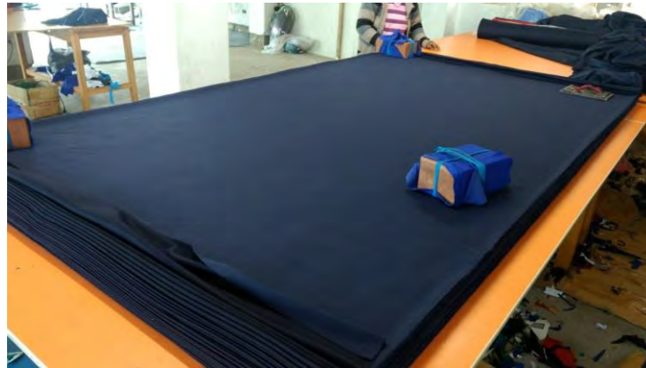
Figura 67: Tendido de tela - buzo sin forro
