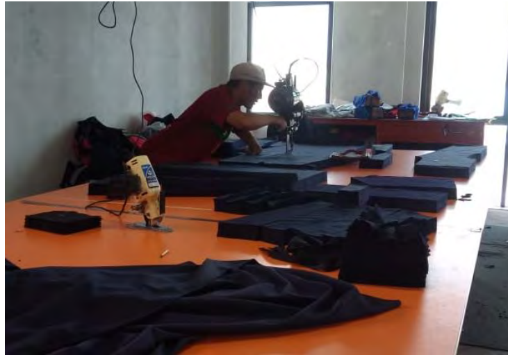
Figura 69: Corte de tela tendida
