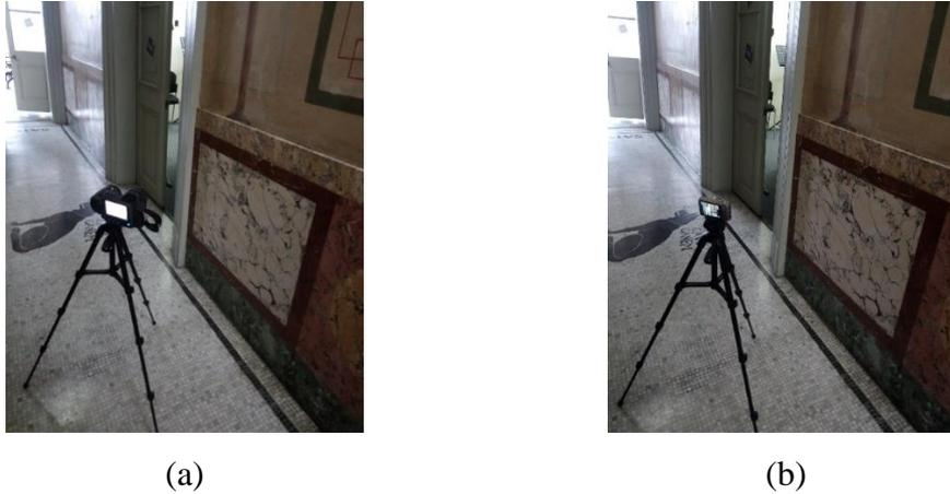
Figura 4.7- Ensayo termográfico pasivo: (a) Toma con la cámara termográfica y (b) toma con la cámara digital.
