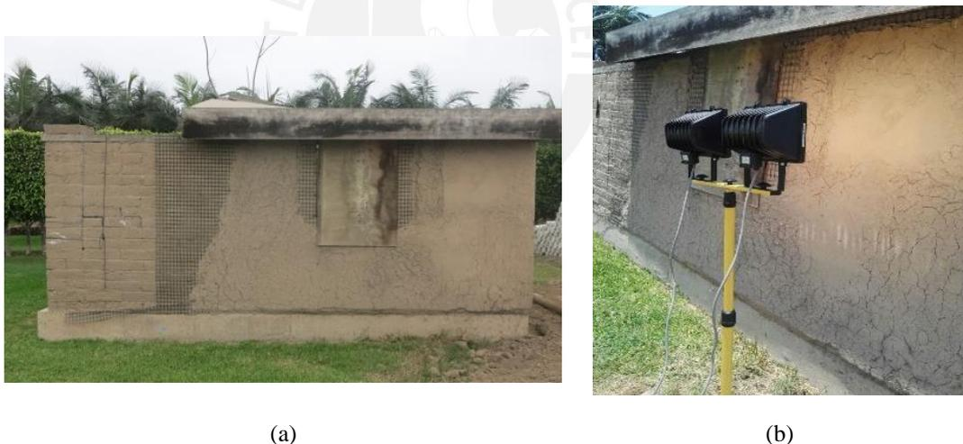
Figura 4.19- Ejecución de ensayos de termografía infrarroja en el módulo de adobe: (a) Fachada oeste del módulo de adobe; (b) Calentamiento de la fachada oeste.
