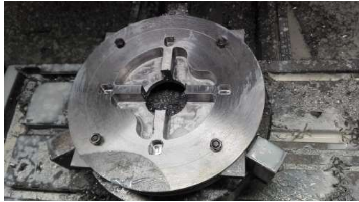
Figura B.7: Bloque de chapas de acero al silicio durante el proceso de mecanizado en una fresadora CNC
