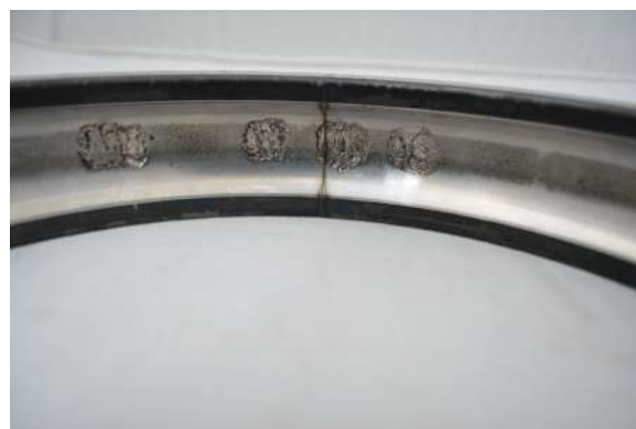
Figura 1.5: Pista de rodadura cuyo modo de falla es de fatiga superficial, asociado a una excesiva carga, en un sentido
