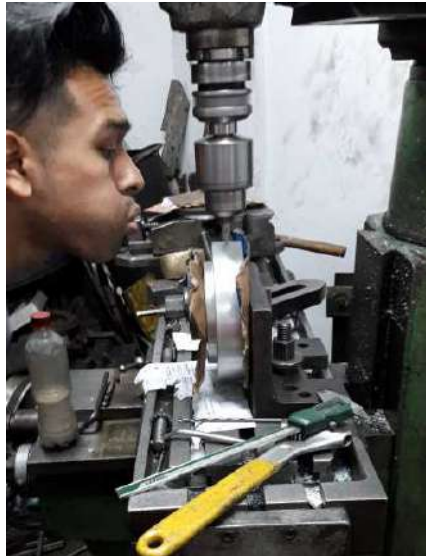
Figura B.5: Taladrado de los agujeros para la tapa portarodamiento
