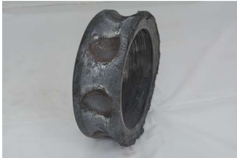
Figura 1.6: Aro interno de un rodamiento fallado por déficit de lubricación, producido por una falla en los sensores de temperatura del rodamiento
