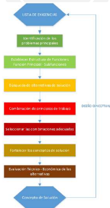
Figura 2.1: Secuencia de etapas que se va a emplear para la ingeniería conceptual del sistema, tomado de [Pahl and Beitz, 2013]
