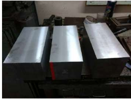
Figura B.2: Bloques de aluminio base para la realización de los soportes
