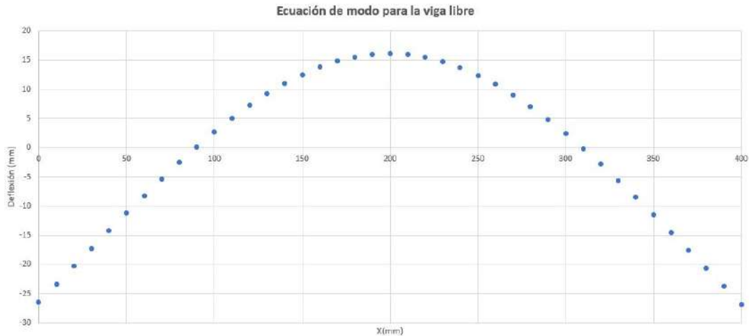
Figura 3.5: Primer modo de vibración de la viga, basada en la ecuación de modo
