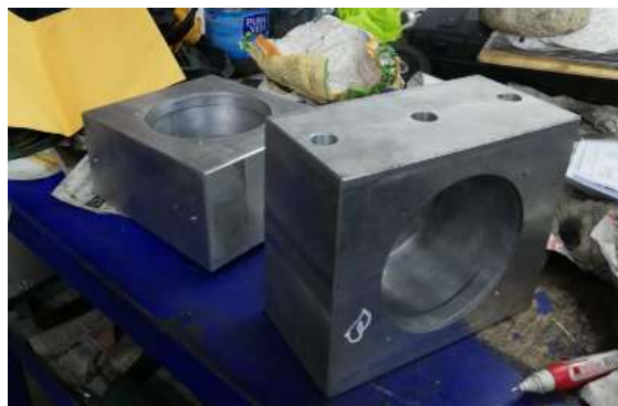
Figura B.4: Soportes fabricados de aluminio para los cojinetes magnéticos
