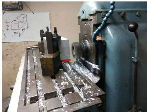
Figura B.3: Refrentado frontal con una fresadora de husillo horizontal
