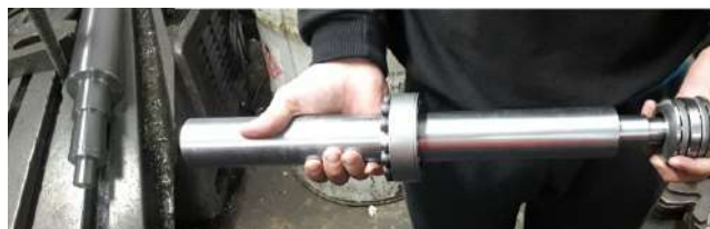
Figura B.1: Rotor fabricado a partir de una barra de AISI SAE 1045
