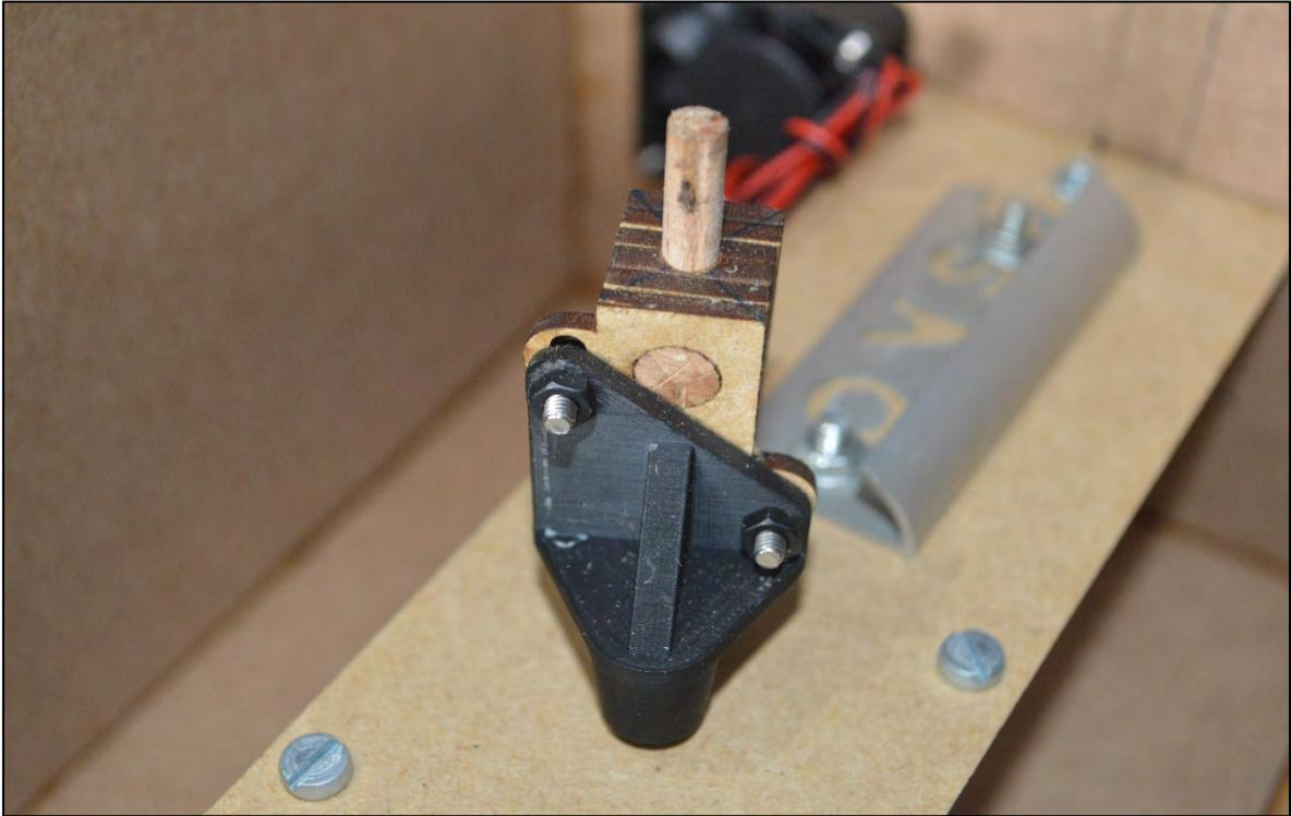
*Figura 23. Detalle de piezas plásticas diseñadas e impresa en 3D.*
