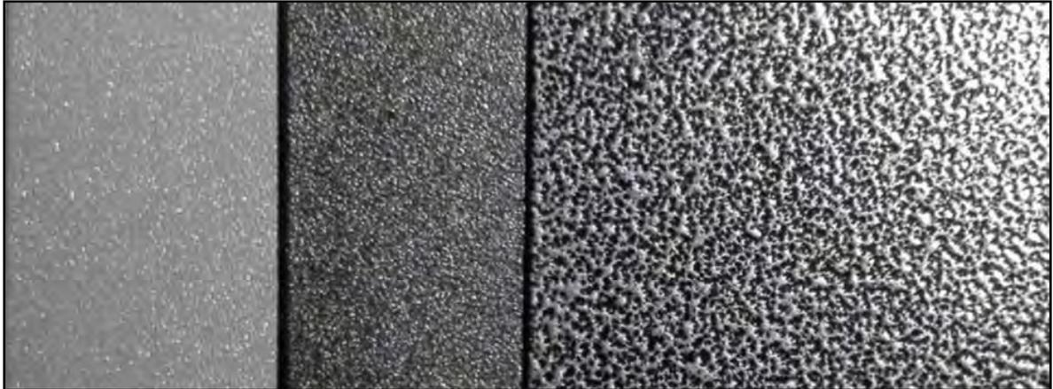
*Figura 52. Detalle de acabado pintura electrostática.*
