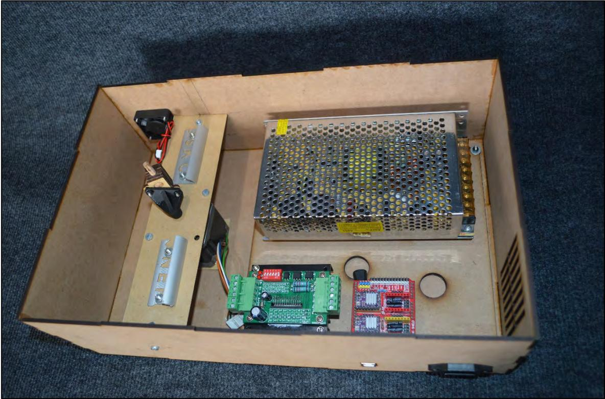
*Figura 21. Detalle del ensamblaje interno de componentes 2.*
