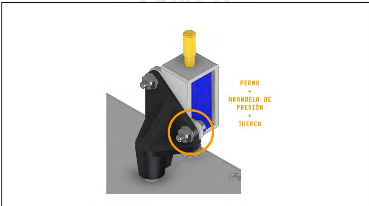
*Figura 66. Detalle de sistema de uniones entre componentes.*
