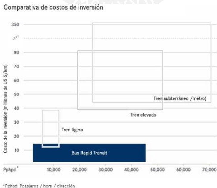
Figura 2-1: Comparación de costos de inversión en sistemas masivos de transporte público Fuente: Mercedes Benz, 2018
