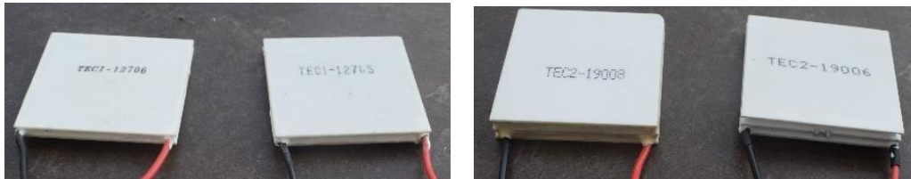
Figura 10: Celdas Peltier. Estándar – una etapa (izquierda), de dos etapas (derecha)
