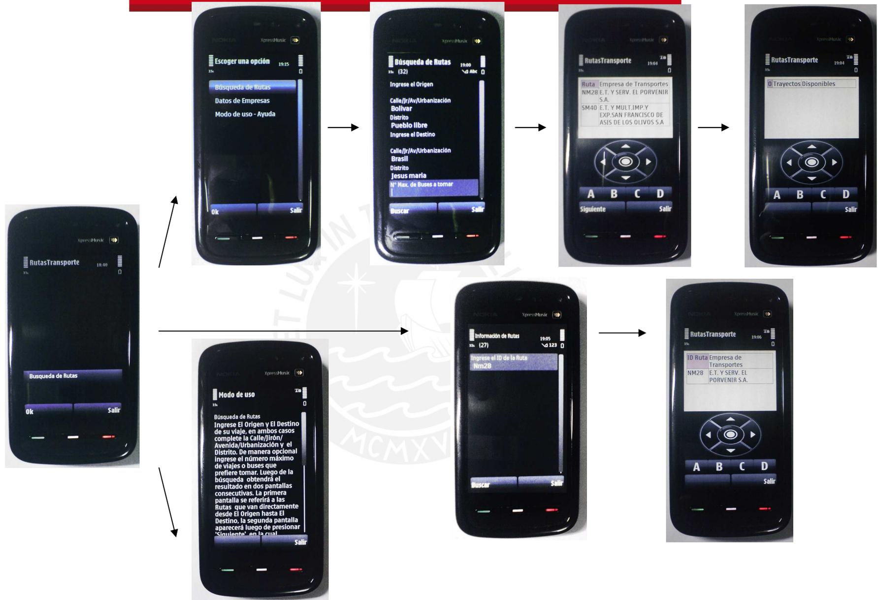
FIGURA 5-2. FLUJO DE EJECUCIÓN DE LA APLICACIÓN EN EL TERMINAL MÓVIL NOKIA 5800 XPRESSMUSIC
