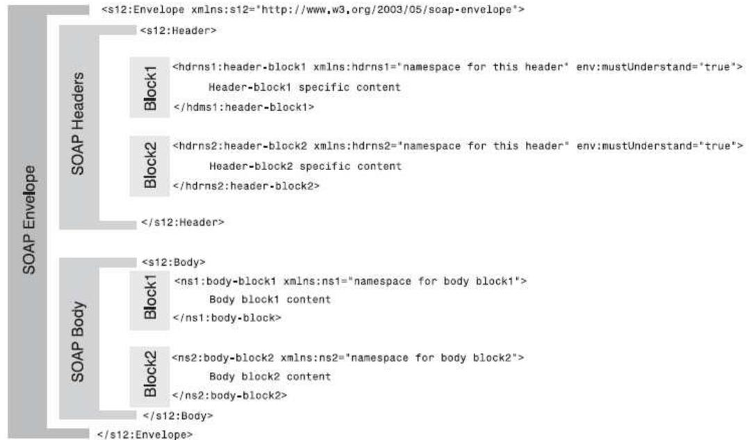
**FIGURA 1-3: ESTRUCTURA DE EMPAQUETADO SOAP**
