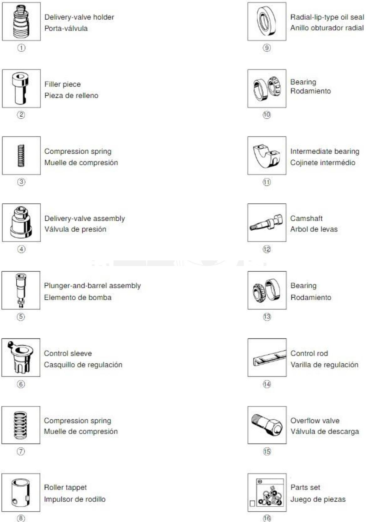
**Figura 4.-** Identificación de las piezas de una bomba de inyección PE(S) P. [2].
