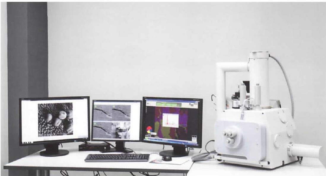
**Figura 21.-** Microscopio Electrónico – Quanta 650 – FEI, con detector (EDS) EDAX Team.
