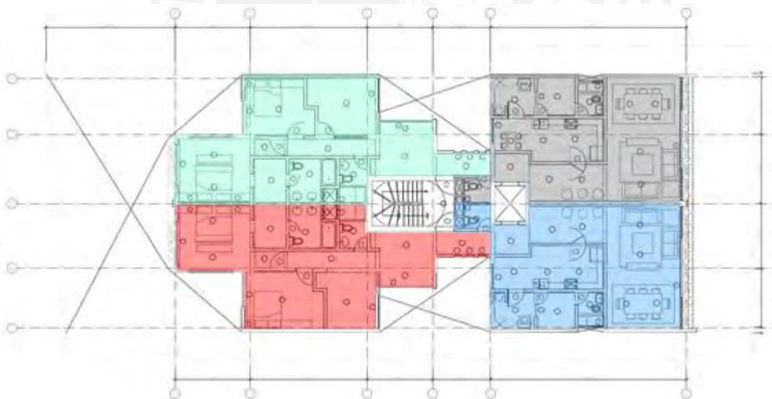
*Ilustración 29. Distribución de los circuitos en los pisos típicos*
