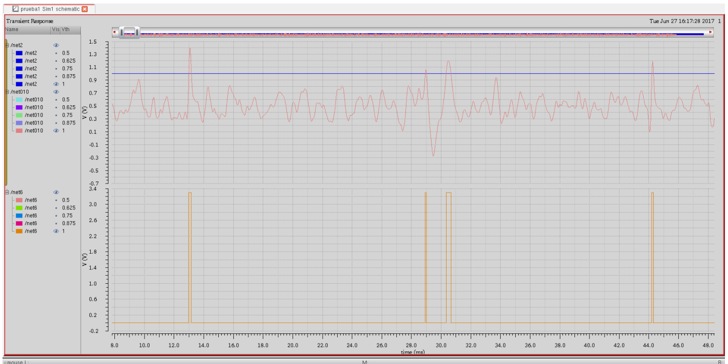
Figura 4. 8: Salida del comparador con V_{th}= 1V
