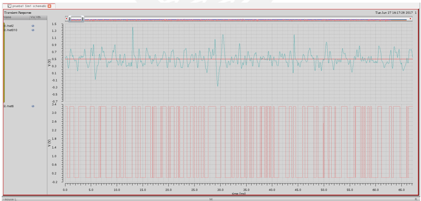
Figura 4. 7: Salida del comparador con V_{th}= 750mV
