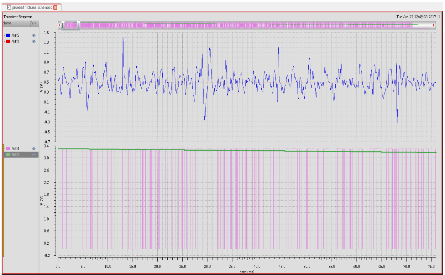
Figura 4. 10: Respuesta filtro RC con señal de salida del comparador con entrada neuronal
