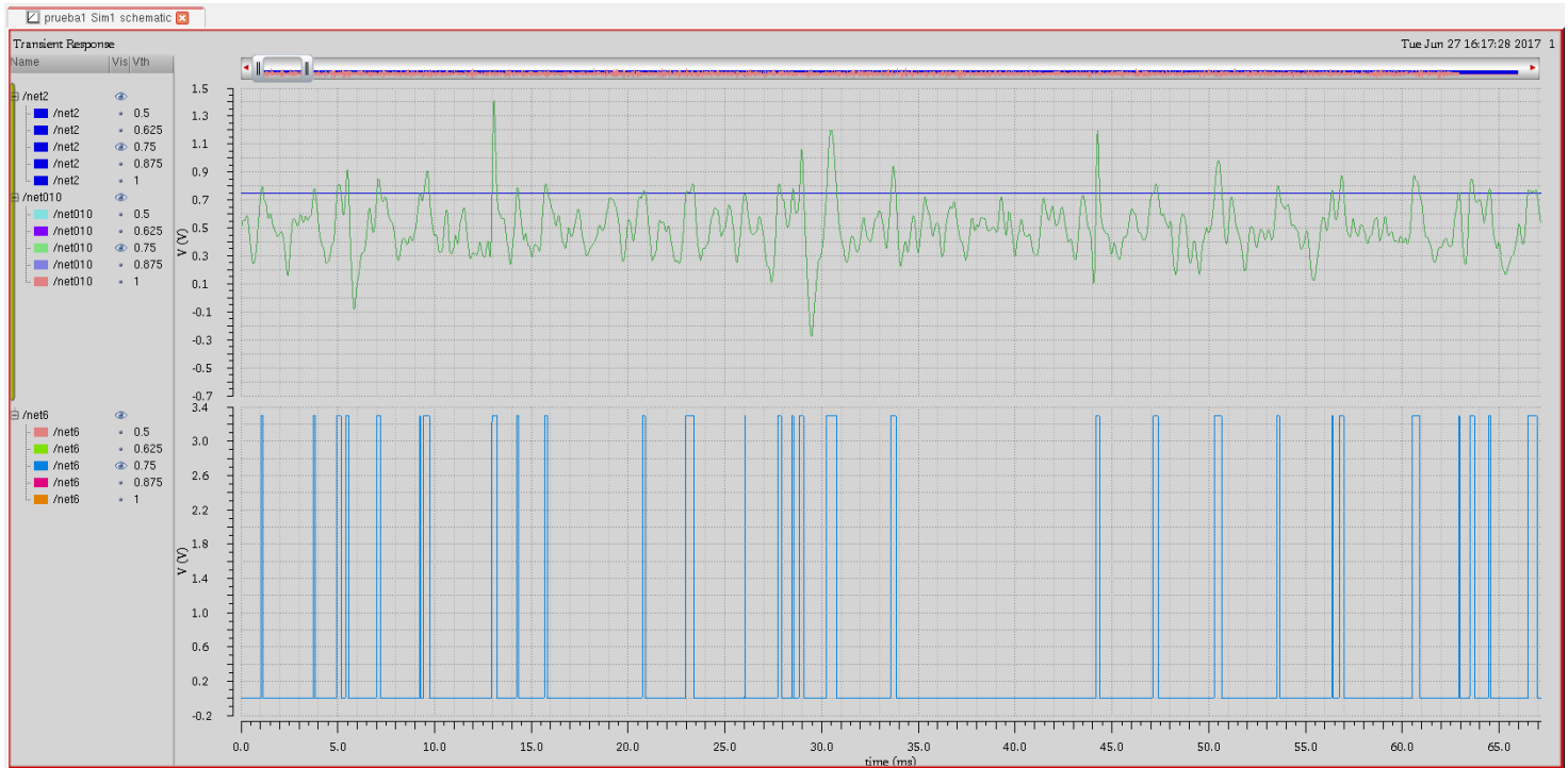
Figura 4. 6: Salida del comparador con V_{th}= 500mV
